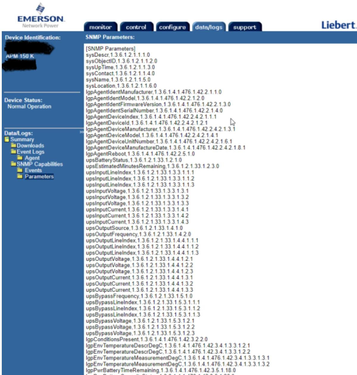
En mi caso el parámetro aparece como **System Output Power,1.3.6.1.4.1.476.1.42.3.9.20.1.20.1.2.1.4208** <note>con herramientas como [snmp tester](#) podemos comprobar un dispositivo Configuramos nuestro item
