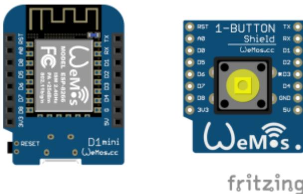
Simplemente ponemos el button Shield encima del Wemos verificando que coinciden las patillas de cada módulo.
