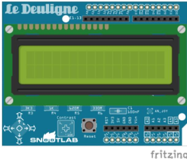
Este tipo de LCD ya viene preparada para conectar directamente encima del arduino Uno o del Mega, pero en nuestro caso al utilizar el nano tenemos que hacer las conexiones siguientes:
